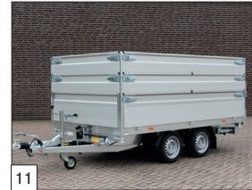
11 Optie: afneembare aluminium opzetborden van 30 of 40 cm hoog.
