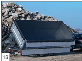
13 Optie: pendel-opzetborden met fijnmazig ladingnet (gemonteerd).
