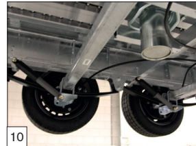
10 Optie: paraboolvering incl. schokbrekers op de assen.
