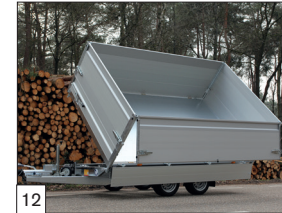
12 Optie: aluminium opzetborden 70 cm hoog, pendelbaar.
