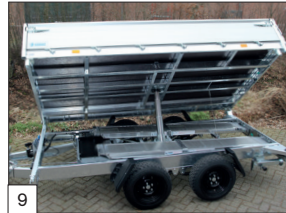
9 Optie: Oprij-pakket met paraboolvering.
