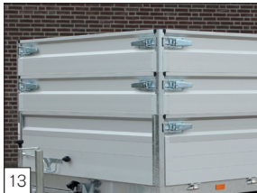
13 Optie: zijborden 400 mm hoog en 2x set aluminium opzetborden 300 mm hoog, afneembaar.
