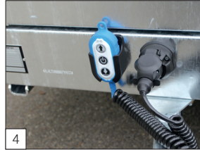
4 Standaard: afneembare bedieningsknoppenkast voorzien van verlengde spiraalkabel.
