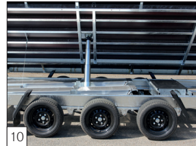
10 Standaard: de 2- en 3 assige uitvoeringen zijn voorzien van paraboolvering incl. schokbrekers en banden 195/50 R13 met zwarte velgen.
