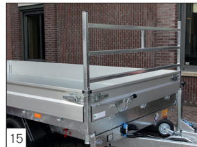
15 Optie: voorrek gemonteerd aan voorzijde.
