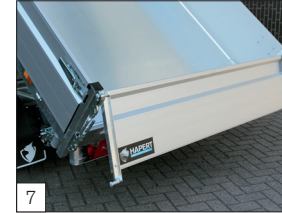
7 Optie: boven- en onder scharnierend achterbord gemonteerd (alleen mogelijk in combinatie met borden 400 mm hoog).
