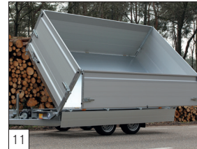
11 Optie: aluminium opzetborden 700 mm hoog, pendelbaar en afneembaar.
