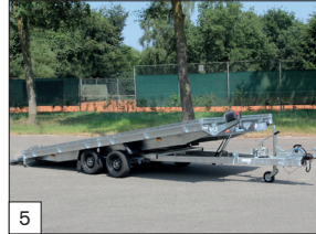
Standaard: paraboolvering incl. schokbrekers bij de modellen in 450 en 505 cm. lengte (hierdoor verlaagde laadvloerhoogte van 625 mm.).
