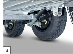
Paraboolvering incl. schokbrekers (in 405 cm. lengte niet leverbaar met paraboolvering).
