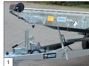
Standaard: met dubbelwerkend hydraulisch kipsysteem, en een vaste Combi Protect Rail 80 mm hoog, gemonteerd.
