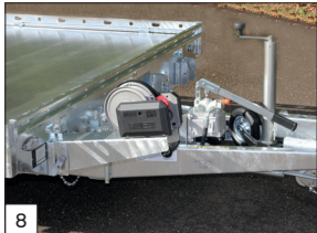
Standaard: afneembare en verstelbare lier met steun gemonteerd aan de voorzijde.
