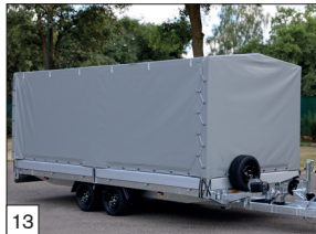
Optie: huif 180 of 210 hoog. Het huif-frame is afneembaar en modulair opgebouwd.
