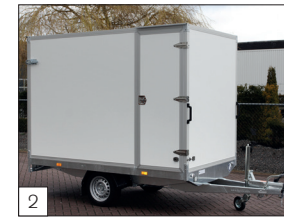
Optie: zijdeur. Standaard voorzien van RVS hang- en sluitwerk en RVS bevestigingsmaterialen.
