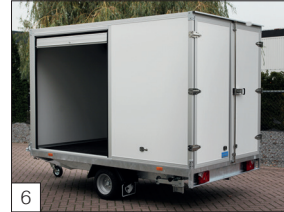
Optie: aluminium rolluik geopend (max. afmeting 210 cm hoog x 150 cm breed) in de zijwand.
