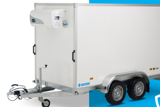
12 Standaard: wanden met gelcoat, dak en vloer 40 mm geïsoleerd.
